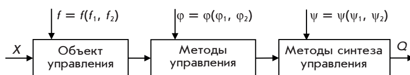
Рис. 3. Подсистема управления упругими колебаниями
